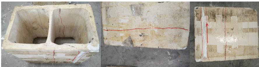
Cracked segment of lining structure (10#) (d)
